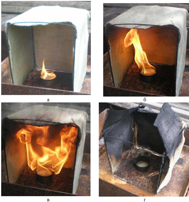
Рис. 5. Результати вогневих випробувань вогнезахисного модельного зразка елементів намету, виготовлених з парусинової тканини: а – запалювання модельного вогнища; б – початок розкладу покриття; в – руйнування конструкції; г – вогнище після горіння
