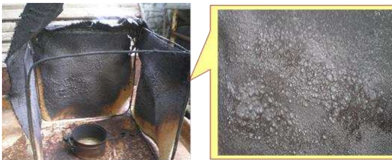
Рис. 6. Результати вогневих випробувань вогнезахисного модельного зразка елементів намету, виготовлених з парусинової тканини: утворення захисного шару коксу при дії полум'я пожежі
